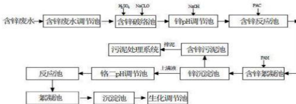
图 7.1-2 含锌废水预处理工艺流程图
