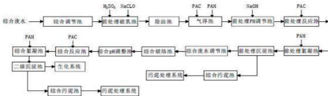
图 7.1-7 综合废水预处理工艺流程图
