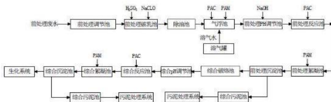
图 7.1-1 前处理废水预处理工艺流程图
